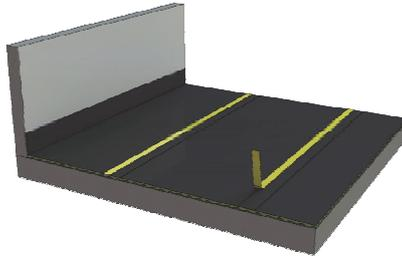
**8)** Die Stöße der Folie mit geeignetem Klebeband verkleben.
