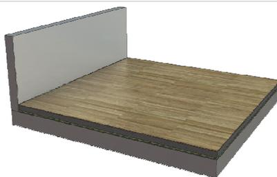
**11)** Überstehende Teile der PE-Folie und des Randdämmstreifens erst nach fertiger Verlegung des Fertigfußbodens abschneiden.
